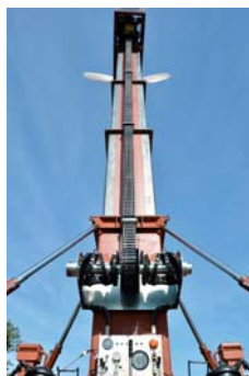
Rys. PM3212-03: igus GmbH, Kolonia „e-spool” w rozsuwanym systemie wentylacyjnym firmy Becker Elektro Stapler Service z miejscowości Ertstadt w Niemczech.
