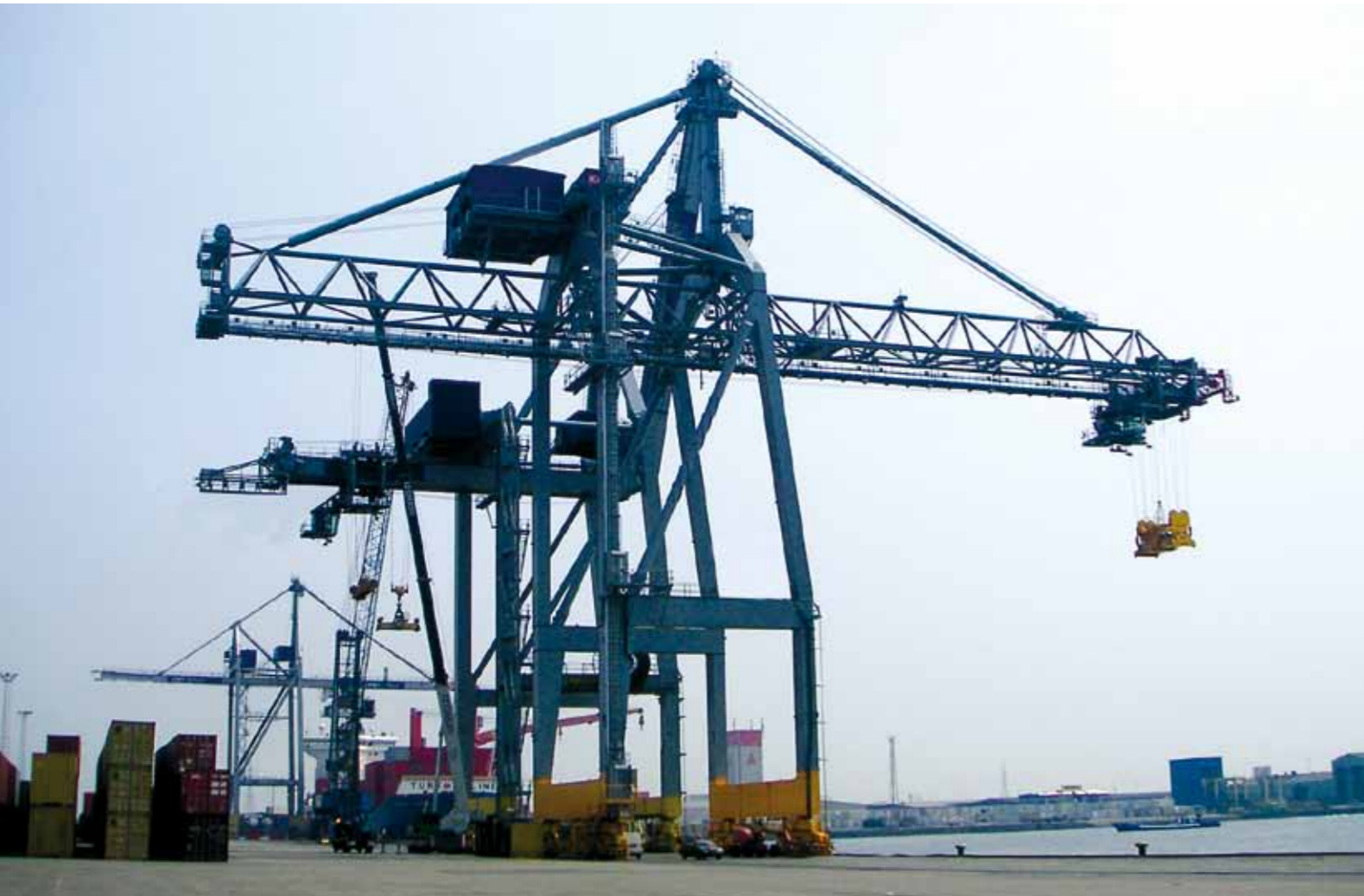
Kein Kabelbahnhof erforderlich – igus® e-kettensystem®-Beispiel STS-Kran in Antwerpen. Das System wurde als readychain® geliefert.
