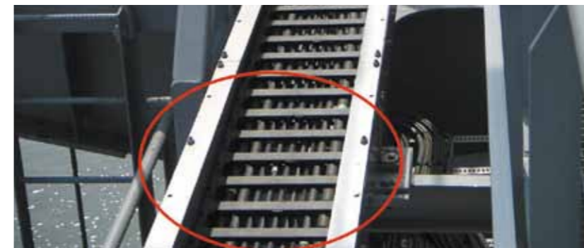
Niederhaltevorrichtungen: readychains® laufen sicher auf langen Fahrwegen und mit hoher Beschleunigung. Die Niederhaltevorrichtung verhindert das Aufsteigen der readychains® bei großen Beschleunigungen des Krans.
