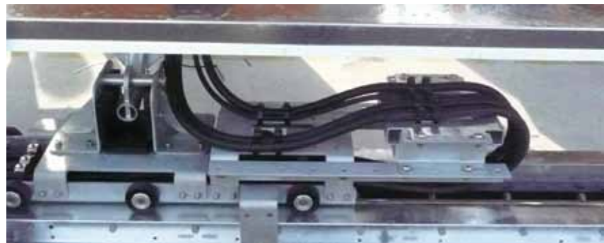
Ausgleich des seitlichen Versatzes bei langen Verfahrswegen
