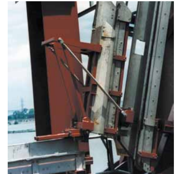
Kupplungsstück: Hafenkrane sind ausgerüstet mit einem Ausleger. Um sicher zu stellen, dass die Rinne auf dem Ausleger und die Rinne auf dem Kranträger korrekt mit der Führungsrinne verbunden sind, hat igus® eine spezielle Befestigung für den Drehgelenkpunkt entwickelt. So kann die Kette auf, neben oder unter dem Kranträger laufen.
