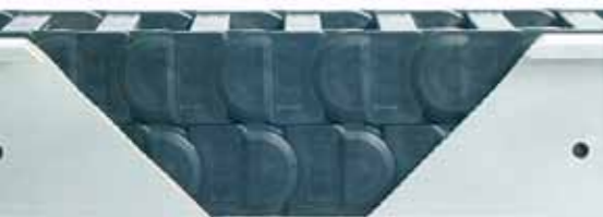
Rinne ohne Gleitschienen – Kette gleitet auf Kette
