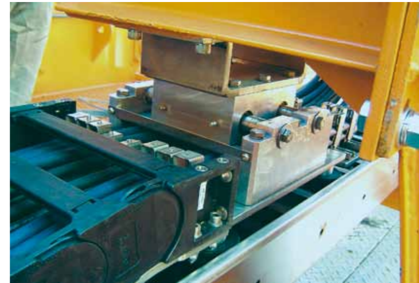
Schwimmender Mitnehmer für den Ausgleich der seitlichen Abweichung zwischen Katz- und Kran-Verfahrweg und der readychain®. Optional mit elektronischer Push-Pull-Verschiebekraft-Überwachung mit ständiger Soll-/Ist-Parameterüberwachung und Notstop-Funktion.
