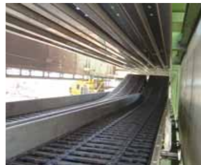
Hohe Zusatzlast bei Heavy-Duty-Ketten
