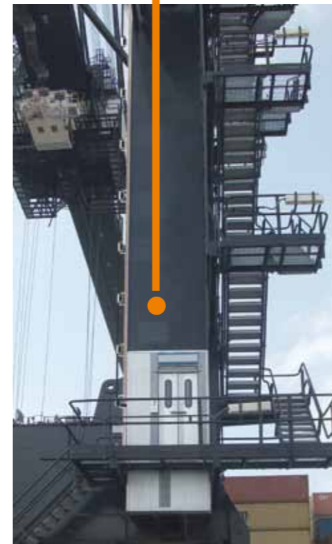
Personenaufzug: Leitungen, geführt von guidelok slimline
