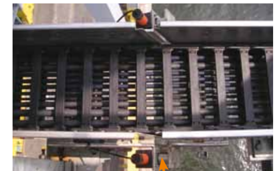
Kupplung am Kupplungspunkt inkl. Endschalter zur Überwachung der Verbindung.
